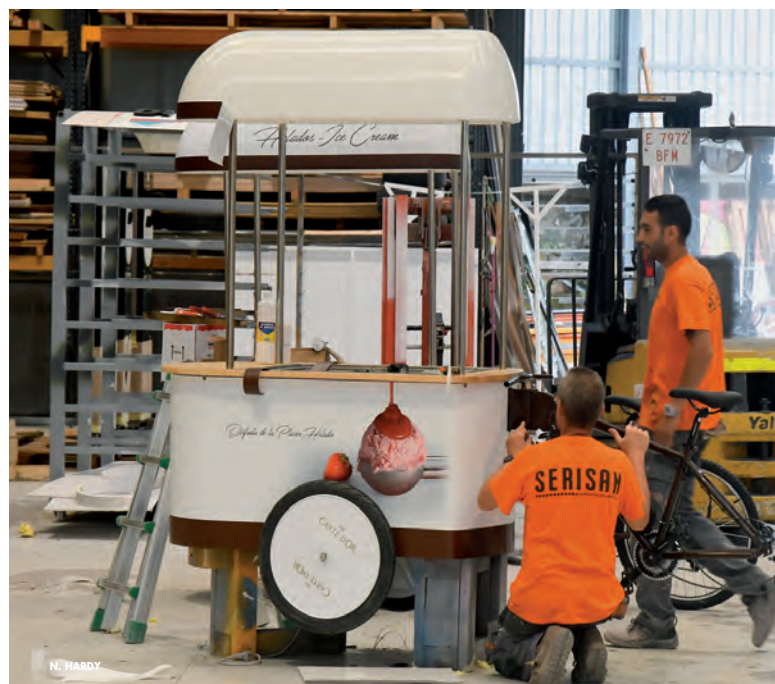
A la izquierda, los últimos trabajos de acabado sobre una gastroneta, en su versión quiosco, no remolcable por tanto. Arriba, uno de los carritos de bicicleta, otro de los productos de la línea de estructuras autoportantes para el punto de venta.
